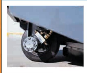
Stufenloser, hydrostatischer Fahrtrieb (auch bei Batteriebetrieb)
